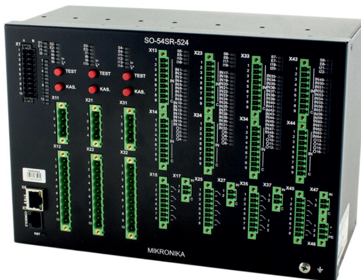
Rys. 4. Widok sterownika SO-54SR-524 bez zabudowanego modemu, z potrójnym sygnalizatorem zwarć, 64 wejściami dwustanowymi i 16 wyjściami dwustanowymi; konstrukcja zgodna ze standardem Energa AMI-SG jako element zespołu sterowniczego 2W
